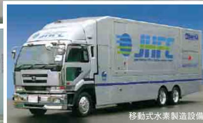
移動式水素製造設備
